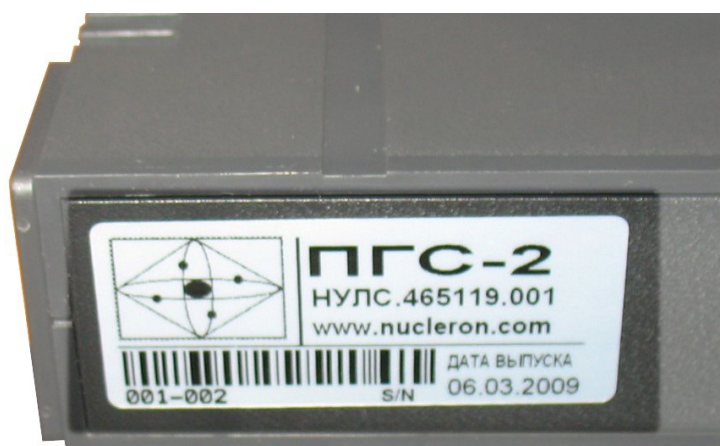
Рисунок 9 - Расположение маркировки на задней стенке блока ПГС-2 Изделие предприятием-изготовителем не пломбируется.
