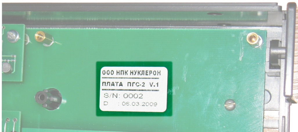
Рисунок 8 - Расположение маркировки на печатной плате ПГС-2 Маркировочная наклейка блока ПГС-2 располагается на задней стенке.
