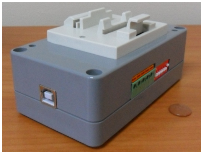
Рисунок 4 - Кронштейн для крепления на DIN рейку
